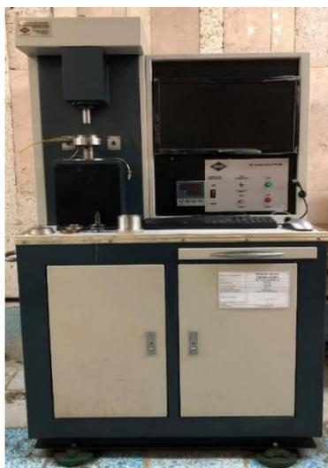
Рисунок 2.6.2 – Внешний вид машины трения МТ-393
