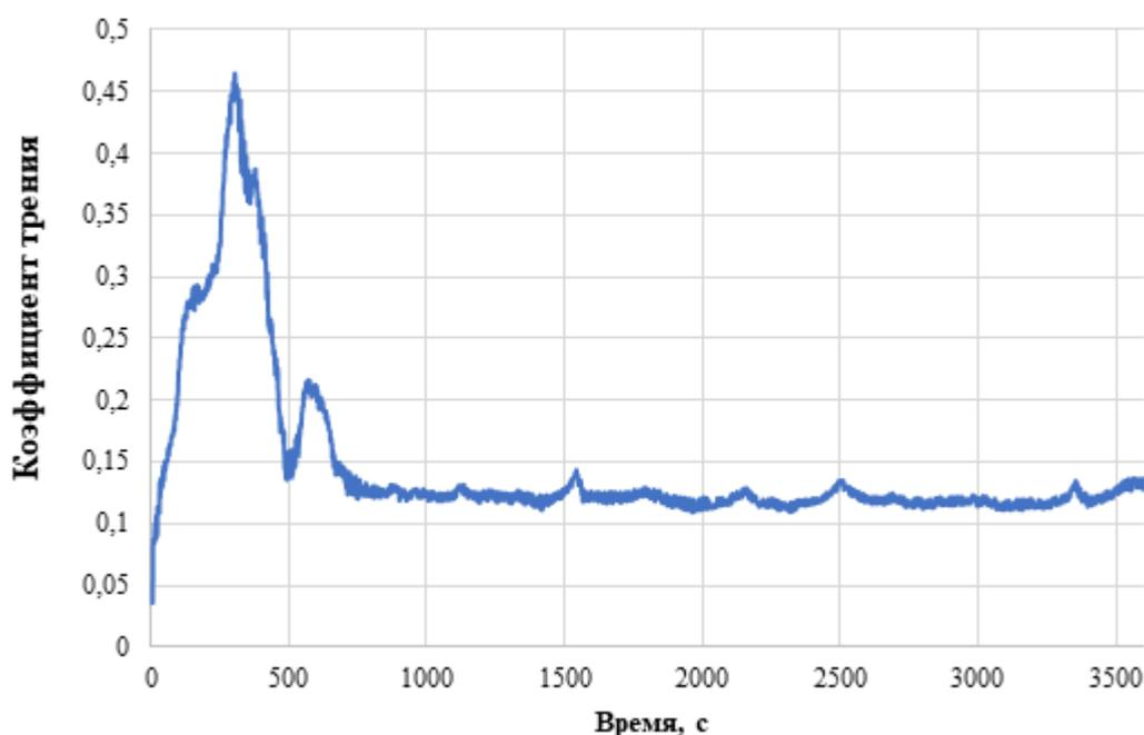
Рисунок 4.5.1 – График изменения коэффициента трения в масле ПЭГ в процессе испытания по схеме кольцо-кольцо (пара трения МДО – Сталь ШХ15) МДО-покрытия, сформированного на сплаве Д16.
