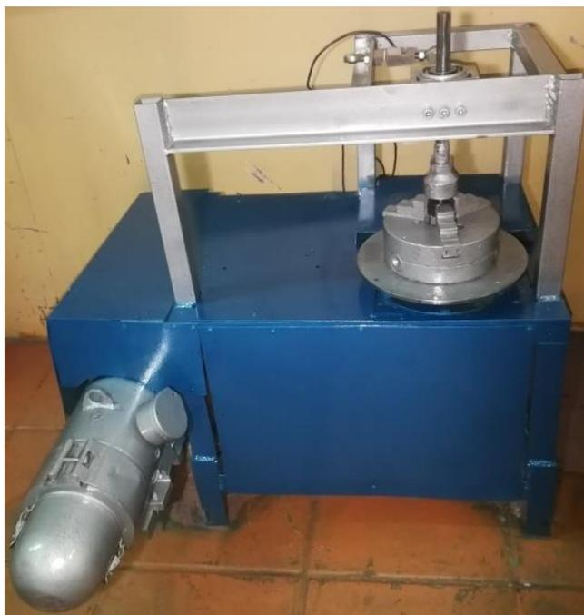
Рисунок 2.7.2 – Установка для испытания резьбовой смазки по ГОСТ ISO 13678 – 2022.
