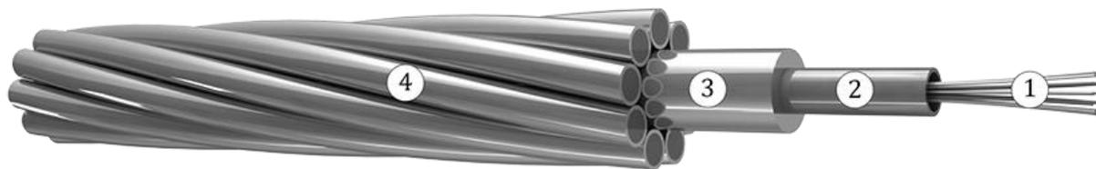
1 – Оптическое волокно; 2 – Оптический модуль из нержавеющей стали, заполненный гидрофобным гелем; 3 – Алюминиевая оболочка стального модуля; 4 – Повив стальных проволок, плакированных алюминием и/или проволок из алюминиевого сплава
