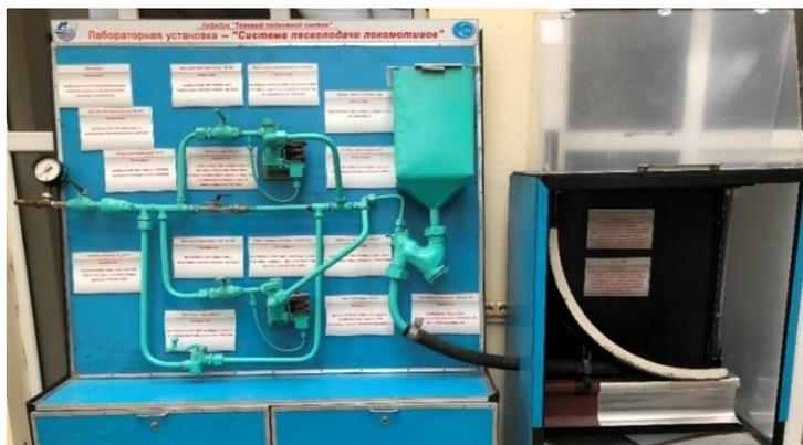
Рисунок 9 – Стенд для испытания модернизированной системы пескоподачи
