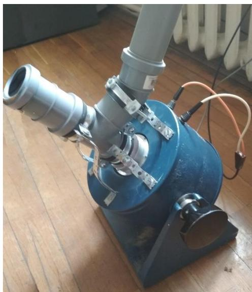
Рисунок 15 – Испытательный электромагнитный вибростенд для определения возможности плавному непрерывному дозированию количества песка путем виброоживления слоя части песка
