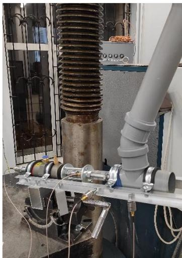
Рисунок 17 – Испытательные стенды по моделированию непрерывного дозирования количества песка путем виброоживления слоя части песка за счет изменения частоты силового воздействия поршнем пневмопulsатора
