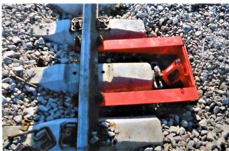
Рисунок 2.8 – Устройство для определения сопротивлений шпал поперечным перемещениям пути [67]
