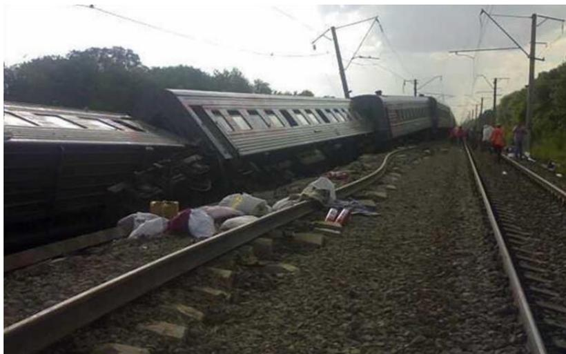
Рисунок 1.4 – Потеря устойчивости бесстыкового пути под поездом на СКЖД (2013 г. перегон Кисляковка-Крыловская)
