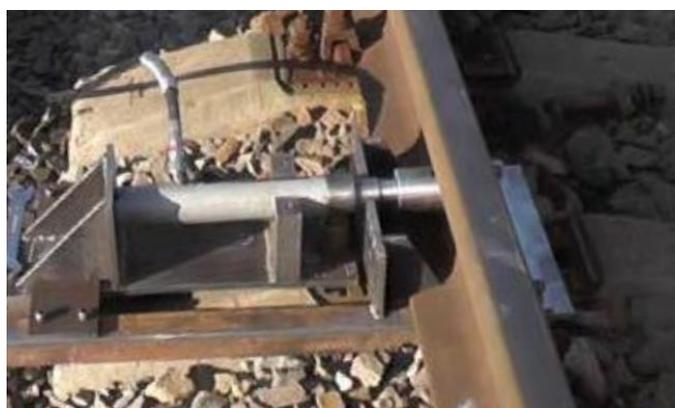
Рисунок 2.7 – Определения сопротивлений шпал поперечным перемещениям пути гидравлическим прибором [66]
