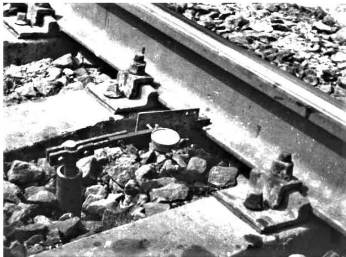
Рисунок 2.12 – Оборудованный створ с индикатором часового типа
