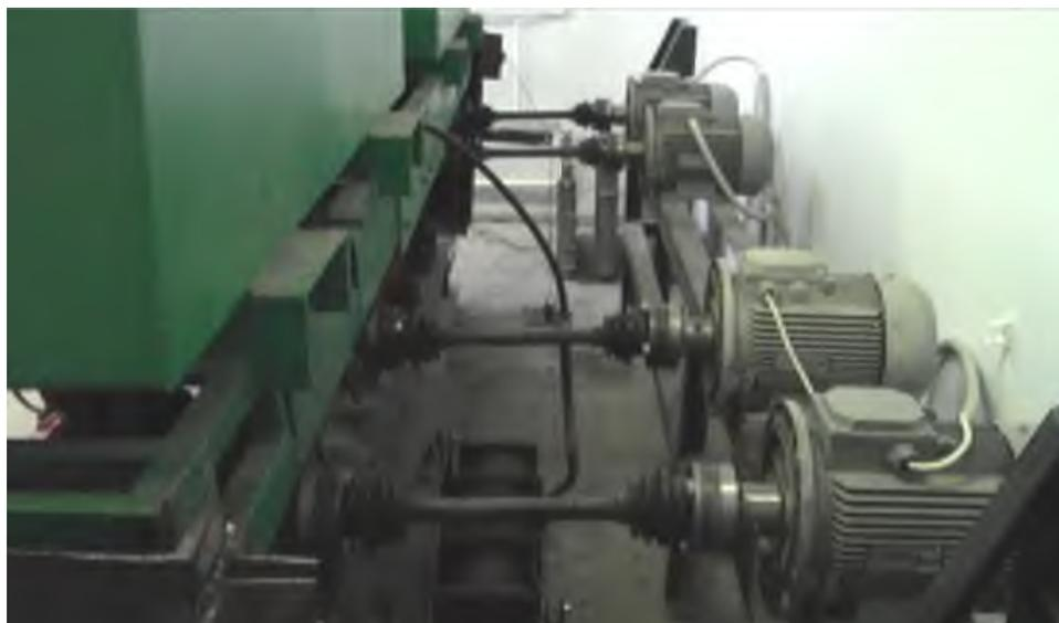
Рисунок 2.21 - Привод катков моделирующих колёсные пары локомотива
