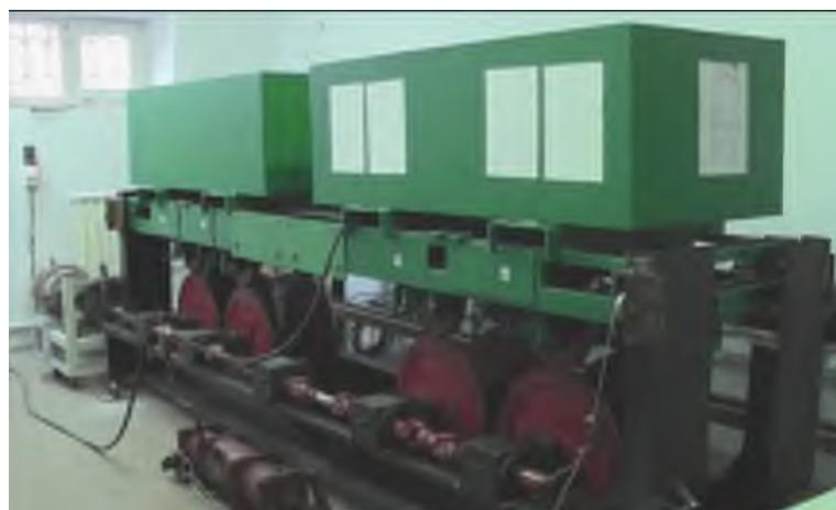
Рисунок 2.20 - Катковый стенд: а) принципиальная схема; б) внешний вид
