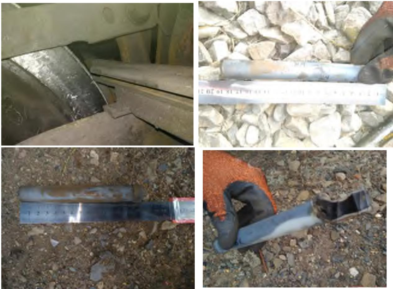
Рисунок 5.12 – Контроль правильности позиционирования экспериментальных стержней и проведение контрольных замеров на маневровом тепловозе ЧМЭ-3э
