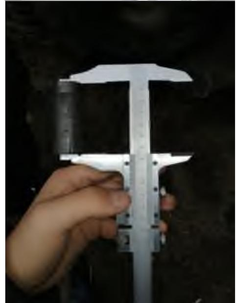
Рисунок 5.17 – Контрольный осмотр и обмеры экспериментальных стержней, установленных на магистральном тепловозе 2ТЭ25КМ
