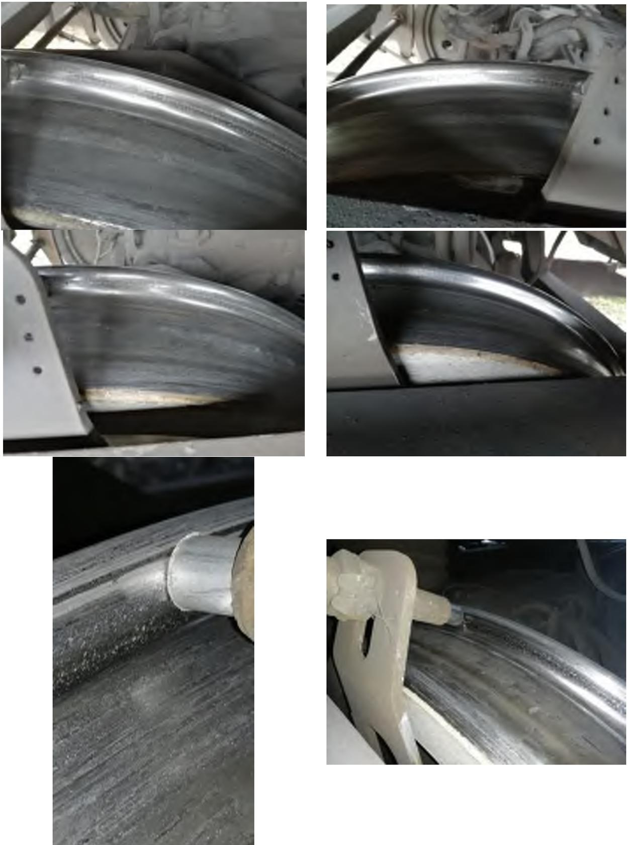
Рисунок 5.13 – Фиксация факта переноса материала на контактную поверхность колеса на магистральном тепловозе 2ТЭ25КМ
