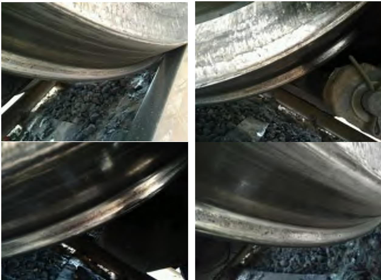
Рисунок 5.14 – Фиксация факта переноса материала на контактную поверхность колеса на маневровом тепловозе ЧМЭ-3э
