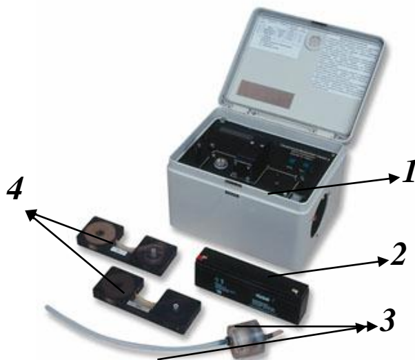
Рис. 2.4. Общий вид газоанализатора с химкассетой и фильтром: 1 – газоанализатор ГАНК-4, 2 – встроенный аккумулятор с зарядным устройством, 3 – воздухозаборный зонд с противопылевым фильтром; 4 – химкассеты
