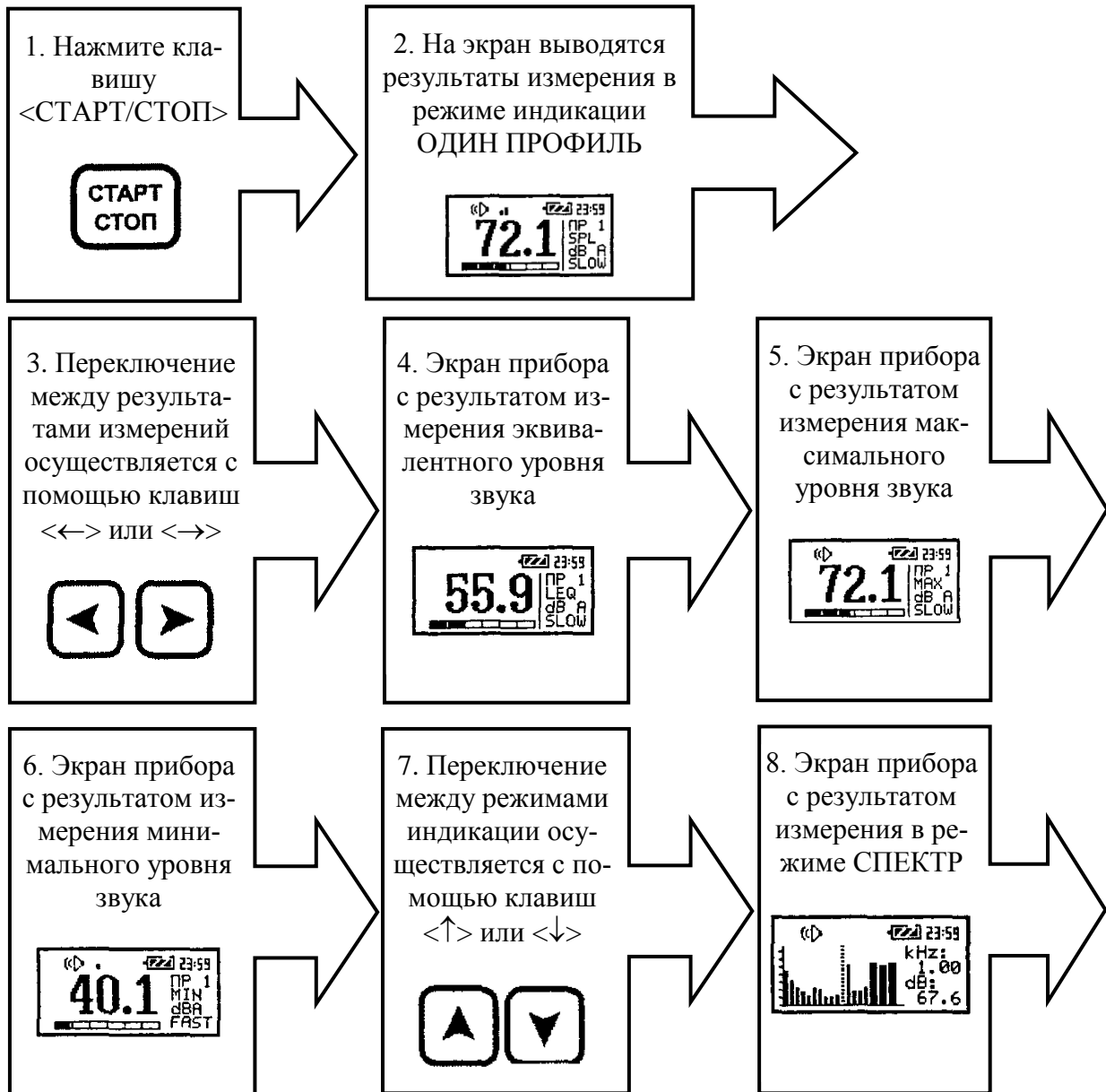
Рис. 6.3. Схема проведения измерений шумомером SVAN-945A
