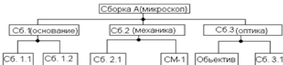
Рис. 4. Схема сборки микроскопа и длительность операций
