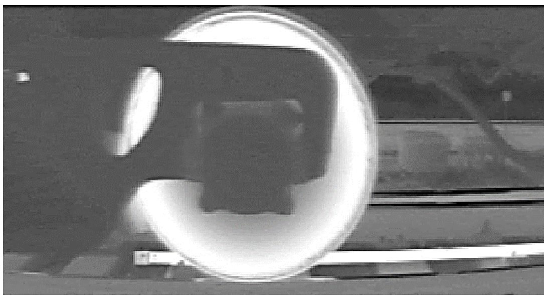
Рисунок 3.4 – Термограмма перегретого колеса
